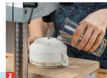
**2** Schadenfrei bohren Sie mit der Bohrmaschine im Ständer und einem Diamantbohrer (hier Ø 6 mm). Wasser dient zur Kühlung!
