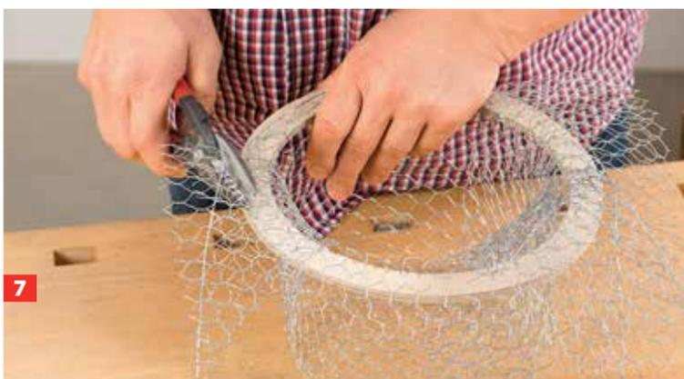
**7** Der zuvor geformte Drahtkorb wird jetzt in den Ring gesteckt, der Rand etwas umgebogen und überstehender Draht abgeknipst.
