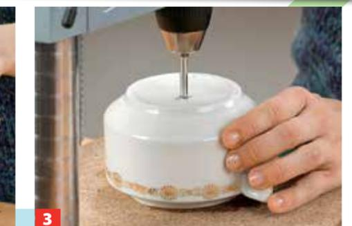
**3** Das Loch nun mit niedriger Drehzahl und nur leichtem Druck bohren. Je nach Dicke kann das schon ein paar Minuten dauern!
