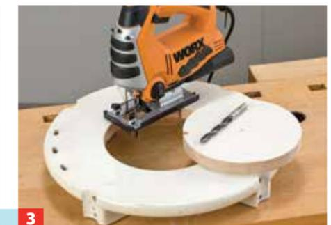
**3** ... Sitzplatte übertragen. Für den Einsatz der Stichsäge ein Loch bohren, dann den Ausschnitt vornehmen.
