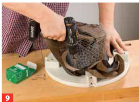
**9** Dann verschrauben Sie den Topf mithilfe des Holzrings quasi kopfüber auf der Unterseite des Stuhls.
