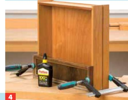
**4** Die Blende wird nun unten bündig vor den aufrecht stehenden Kasten geklebt (Pattex 100 %). Zum Trocknen festzwingen.
